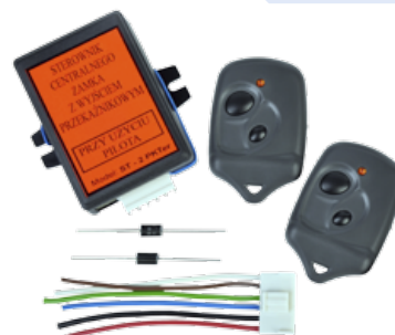
STEROWNIK ZAMKA CENTRALNEGO ST-2PKTER + 2 piloty z wyjściem przełącznikowym oraz sterowanie plusem
